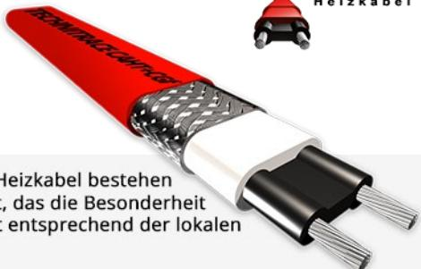
Die CAHT selbstregulierenden Hochtemperatur-Heizkabel bestehen aus einem halbleitenden Kunststoff-Heizelement, das die Besonderheit besitzt, seine Heizleistung ( $\text{W}/\text{m}$ ) an jedem Punkt entsprechend der lokalen Temperatur anzupassen.
